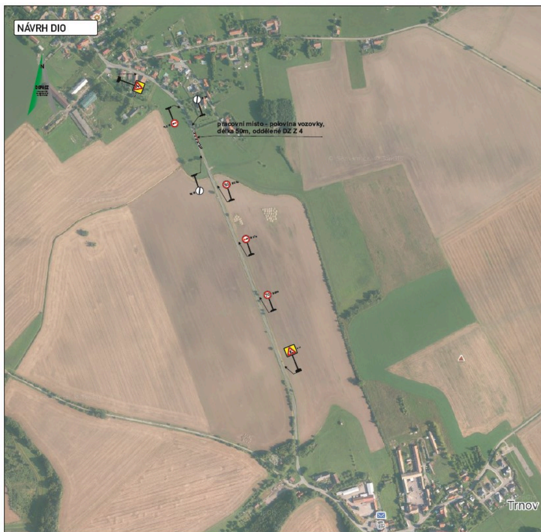
Situační schéma s vyznačeným umístěním přechodného dopravního značení
